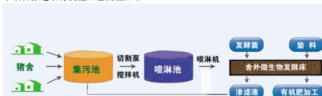
图 4.1-7 猪舍粪污异位发酵床处理系统工艺流程图
